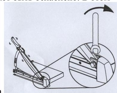
случае, снимите заглушку и закрепите держатель ножа с помощью ключа.
