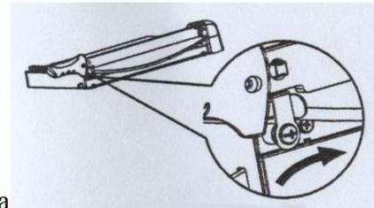
3. Возьмитесь за ручку ножа и осторожно снимите нож с фиксатора
